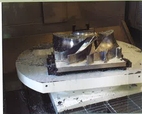
Pièces de validation réalisées en condition réelle sur la machine commandée par le client.
