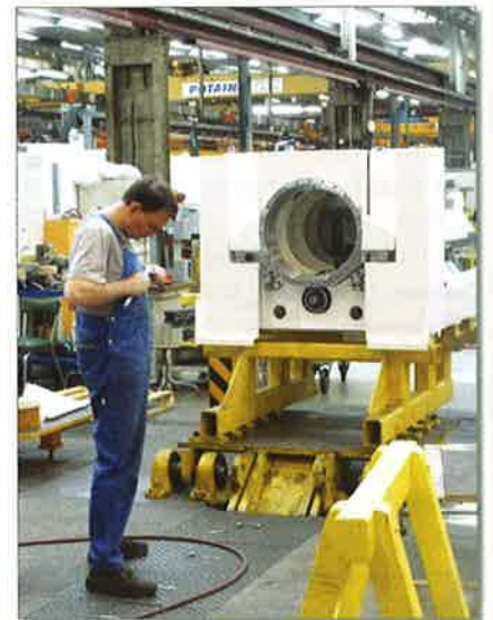
Opération de grattage lors du montage d'un sous-ensemble.
